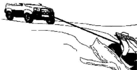
Jednoduché zapojení lana
